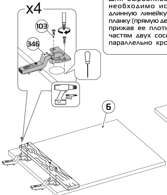
Для выравнивания петель необходимо использовать длинную линейку или прямую планку (прямую деталь каркаса), прижав ее плотно к прямым частям двух соседних петель параллельно кромки фасада.
